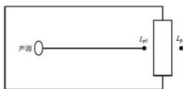
图 4-2 室内声源等效为室外声源图例
