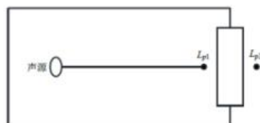
图 4-2 室内声源等效为室外声源图例
