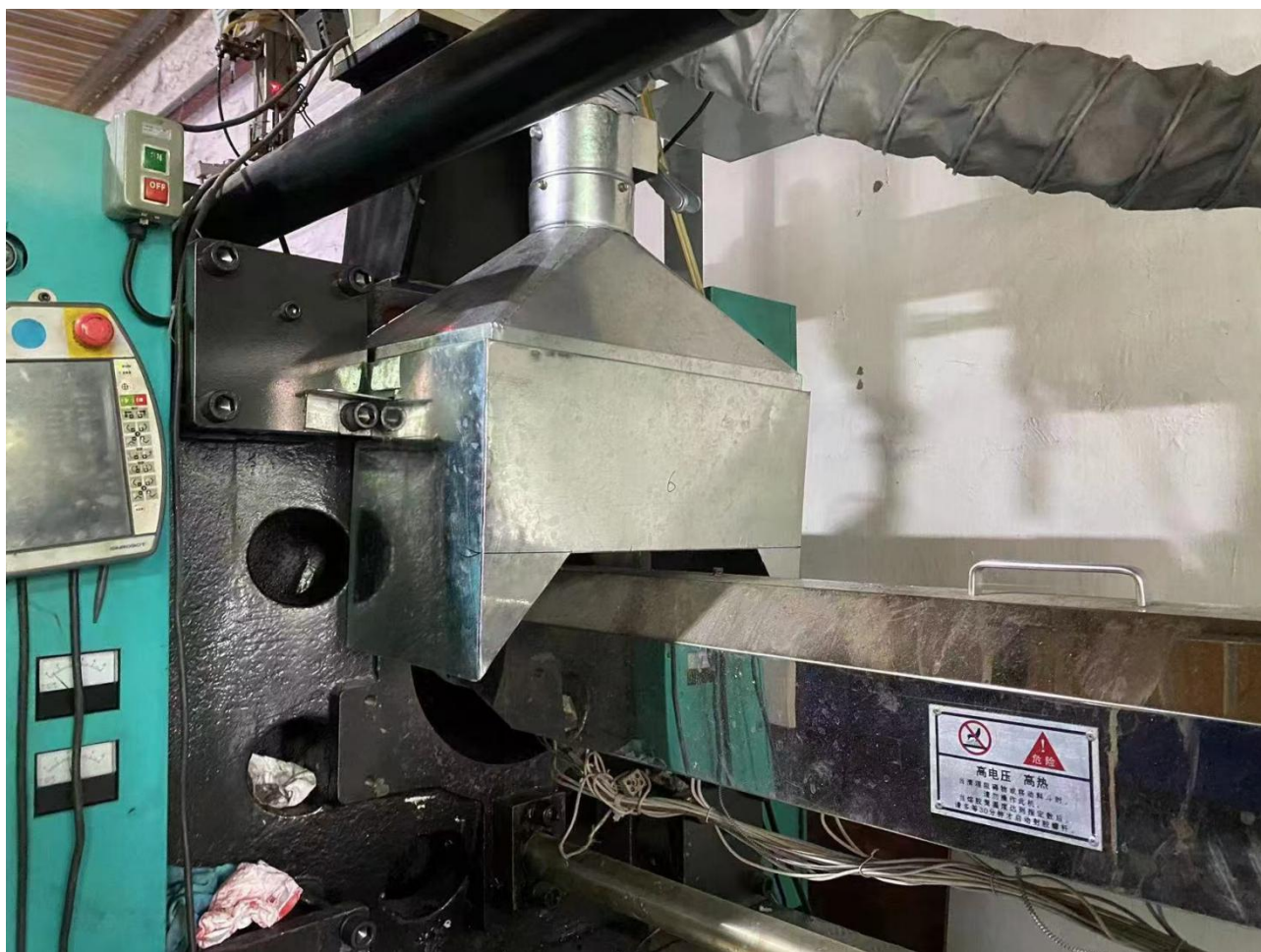
图 4-3 注塑机收集方式---集气罩示意图
