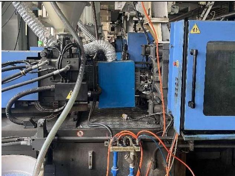
图 4-1 企业废气收集措施示意图(集气罩+三面围挡)
