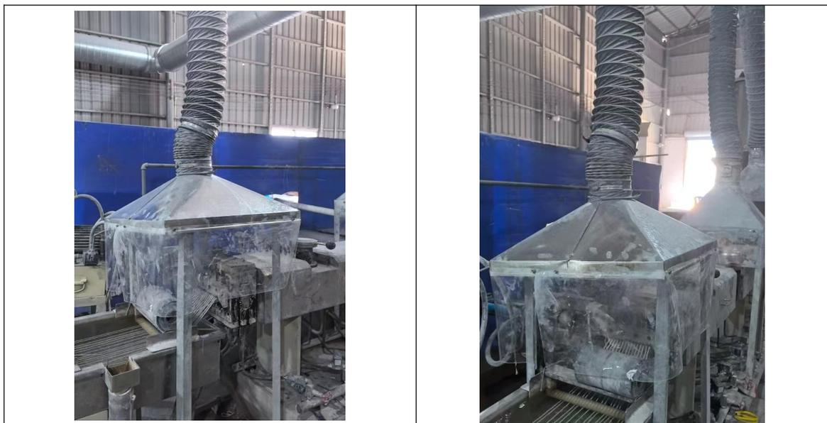
图 4-1 项目废气收集示例图
