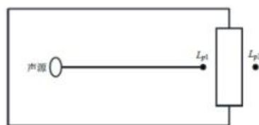
图 4-2 室内声源等效为室外声源图例
